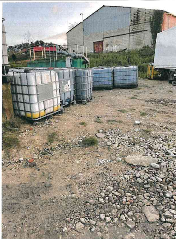
PHOTO 2 – Cuves GRV contenant effluents aqueux sans dispositif de rétention.
